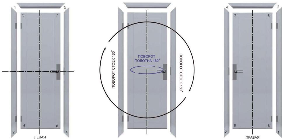
Конструкция моноблока полностью реверсивна, что позволяет изменять сторонность открывания дверного полотна совместно с дверным коробом непосредственно перед монтажом в случае, если планировка помещения изменилась, при этом не меняя уже приобретенные двери.
